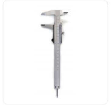
버니어 캘리퍼스 Caliper vernier
